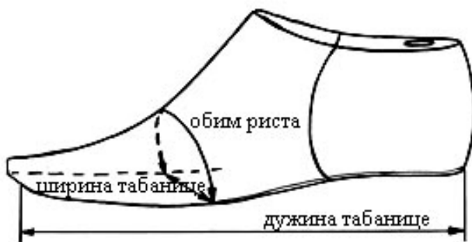
Слика 1 – Основне димензије калупа ципеле на шнир женске са кожным ђоном
