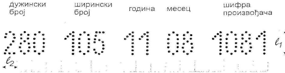
Слика 26 – Изглед означавања на језику ЧВУ М-10
